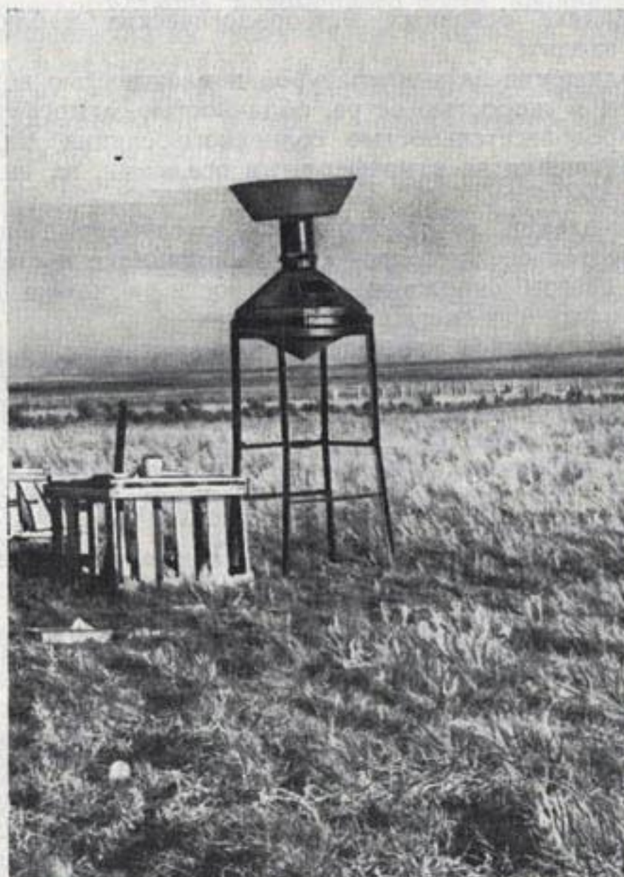
Рис. 3. Суммарный осадкомер в степи.
