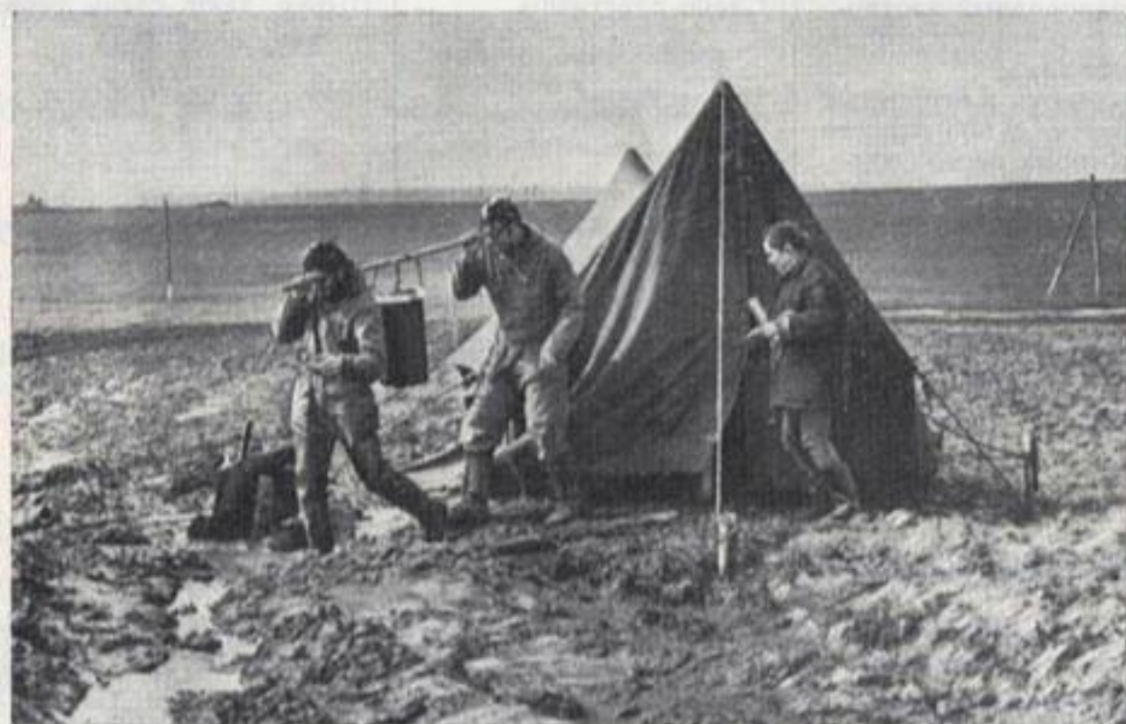
Рис. 18. Простейшее укрытие от сильного ветра для взвешивания испарителей ГГИ-500-50.
