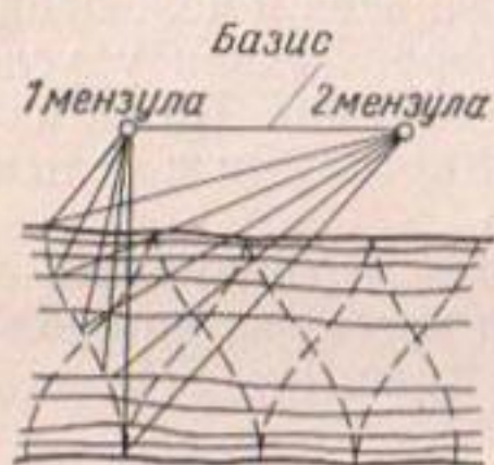
Рис. 108. Схема промеров по косым галсам.
