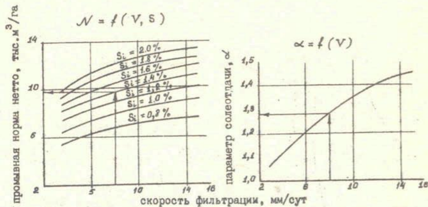
Рис.6 Зависимость параметра засоленности ( \alpha ) от скорости фильтрации ( V )
