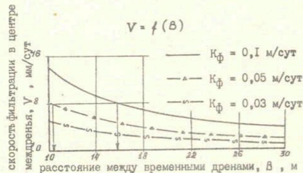
Рис.4 График для определения расстояния между временными дренами при заданной скорости фильтрации в центре междренья
