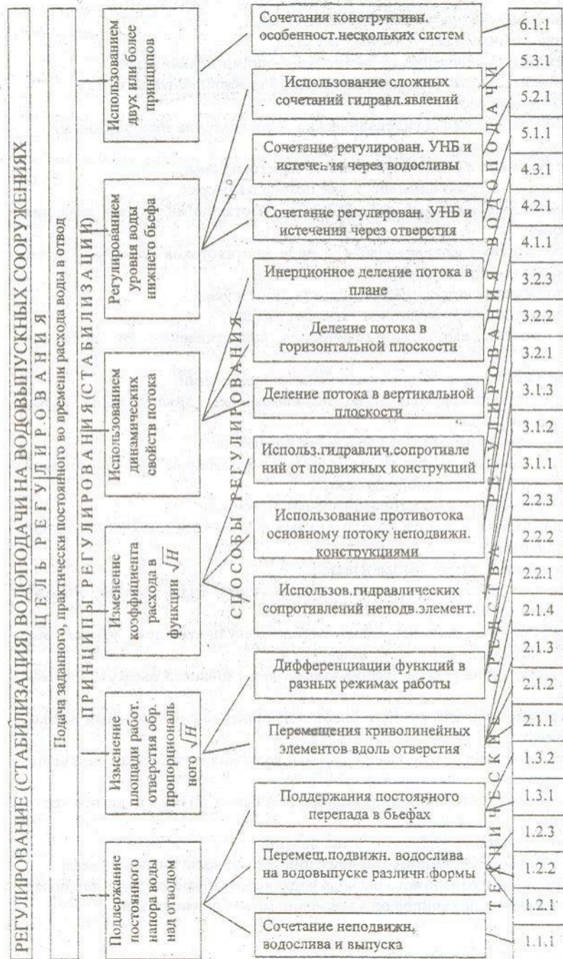
Рис.7. Классификация принципов, способов и средств стабилизации расхода воды.
