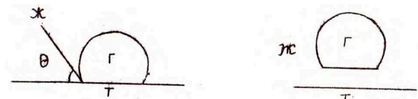
Рис. 3.13. Схема отрыва пузырька от поверхности твердого тела
