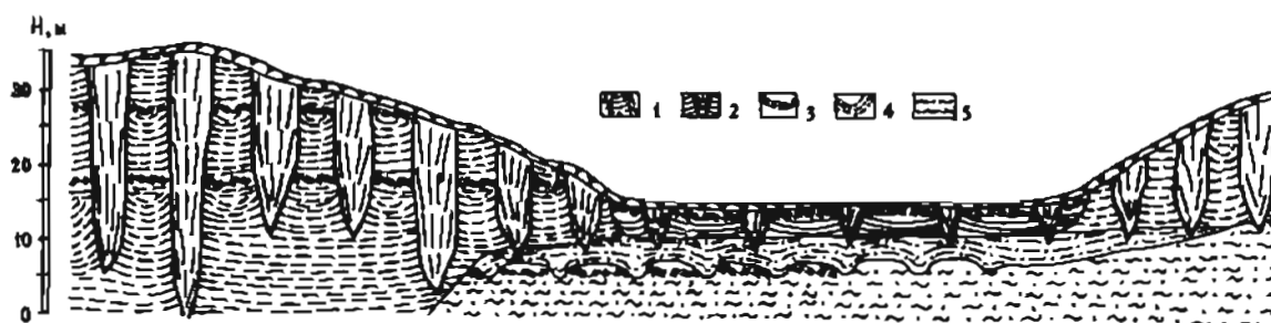
Рис.8.2. Схема строения ледового комплекса на о.Б.Ляховском, по Н.Н.Романовскому. 1 - повторножильные льды в супесчано-суглинистых отложениях основной поверхности едомы, 2 - повторножильные льды в суглинистых отложениях аласа, 3 - погребенные отторфованные почвенные горизонты, 4 - термокарстовые отложения, выполняющие псевдоморфозы по повторножильным льдам, 5 - отложения,вещающие псевдоморфозы
