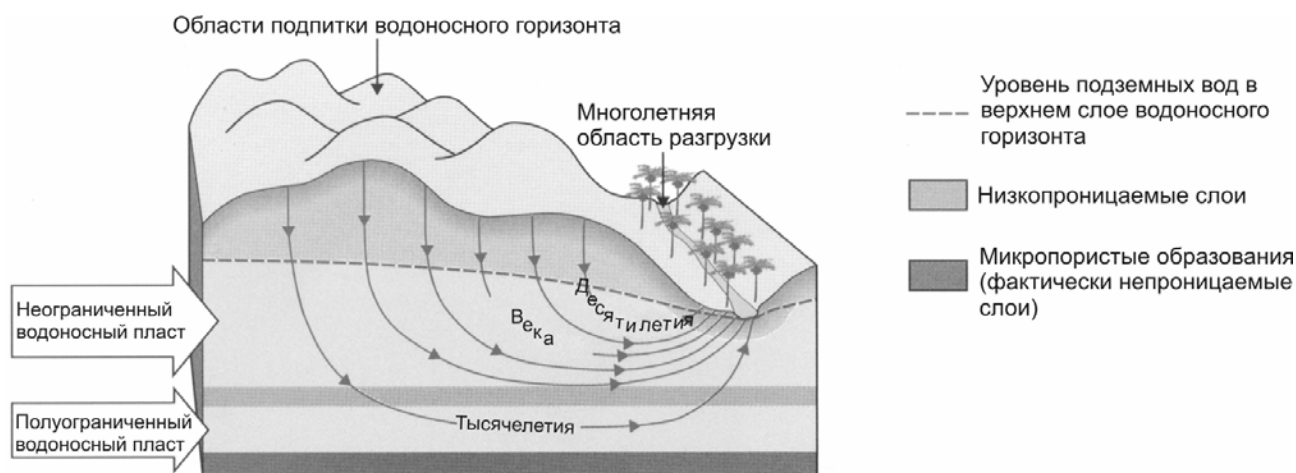
Рис.2. Типичный режим движения подземных вод и время удерживания воды в крупных водоносных горизонтах в полуаридных климатических условиях
