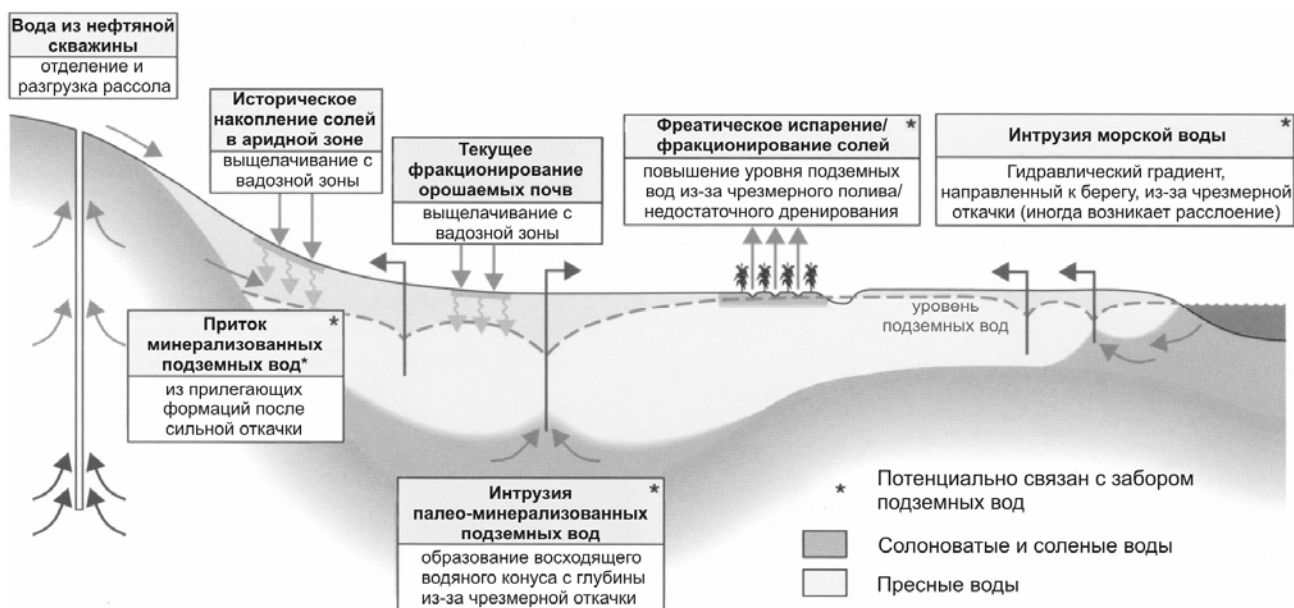
Рис.6. Возможные источники минерализации подземных вод и механизмы засоления водоносного горизонта
